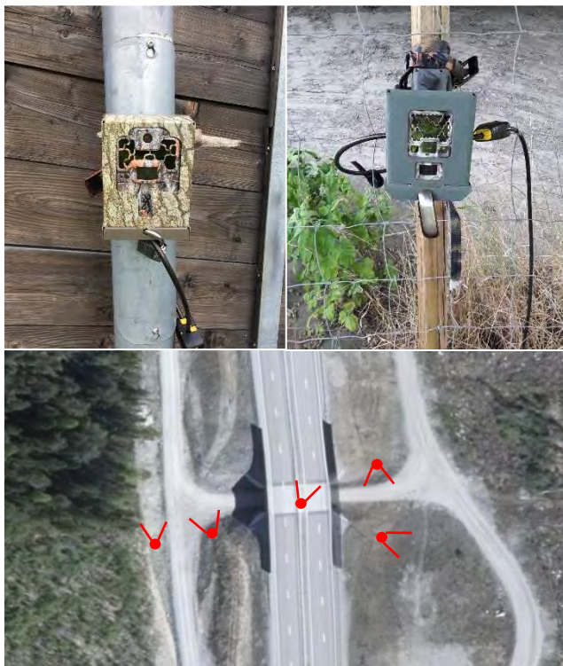
Figur 3: Överst är exempel på viltkameror monterade i fält (Browning (vänster) och Reconyx (höger)). Nederst är ett exempel på indexuppsättning i en underpassage. Mitt i bron finns en passagekamera, och på var sida om E4 finns två referenskameror, som är riktade ut från bron för att observera djur som rör sig i brons närhet.
