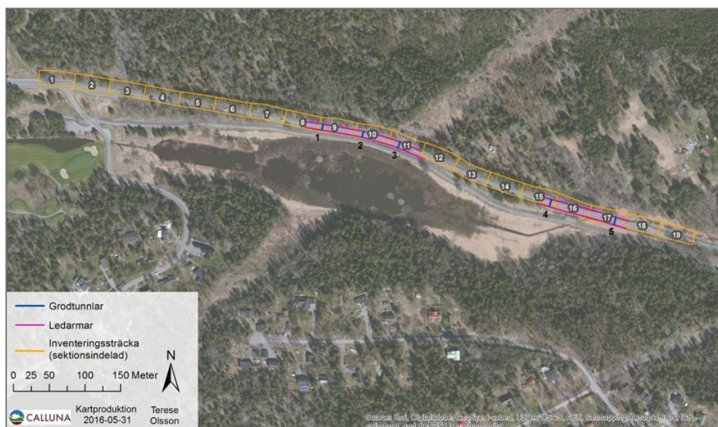
Bild 6. Inventeringssträckan indelad i 50m-sektioner, med tunnlnarna numrerade och ledarmarna markerade som lila linjer.
